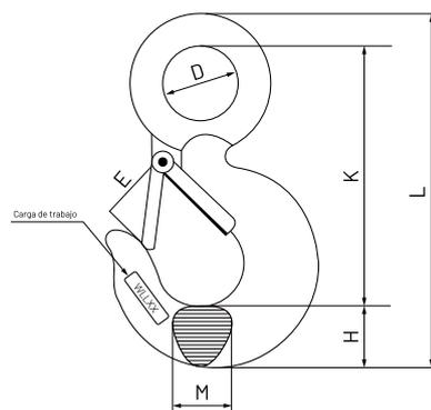
La calidad del muelle activador del seguro le confiere una funcionalidad rápida sin alterar la seguridad que debe comportar el proceso de elevación o desplazamiento de cargas. Cada gancho lleva marcado sobre relieve su correspondiente carga de trabajo en toneladas y con el símbolo identificativo del tipo de material: (C) para los ganchos de acero al carbono y (A) para los ganchos de acero aleado, quedando garantizada su elección.
