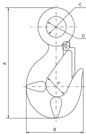
La calidad del muelle activador del seguro le confiere una funcionalidad rápida sin alterar la seguridad que debe comportar el proceso de elevación o desplazamiento de cargas. Cada gancho lleva marcado sobre relieve su correspondiente carga de trabajo en toneladas y con el símbolo identificativo del tipo de material: (C) para los ganchos de acero al carbono y (A) para los ganchos de acero aleado, quedando garantizada su elección.
