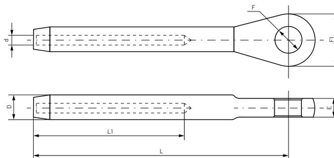
Gracias a su diseño, el terminal cáncamo inoxidable, permite una fácil colocación del cable en el hueco interior para su posterior prensado. Especialmente recomendable para soluciones estéticas en los sectores de la arquitectura e interiorismo.
