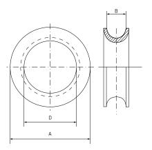
El guardacabo es un elemento imprescindible para garantizar la protección del cable en el momento de producirse cualquier tipo de rozadura o fricción.
