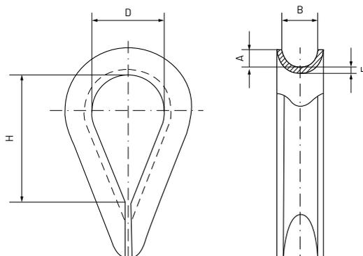
El guardacabo es un elemento imprescindible para garantizar la protección del cable en el momento de producirse cualquier tipo de rozadura o fricción.
