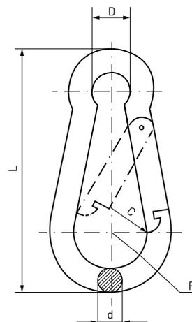
El diseño del gozne permite ser utilizado en montajes rápidos, en donde no esté comprometida la posible apertura de dicho elemento y en usos temporales que precisen ser retirados con continuidad o con premura.
