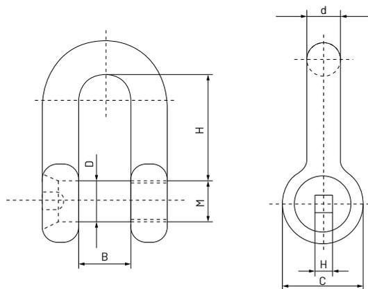
El componente de acero de alta resistencia de su estructura permite la elevación de grandes cargas de trabajo con la elección de un grillete de menor volumen. Además el alojamiento embutido de la cabeza garantiza una mayor seguridad en la elevación de cargas.
