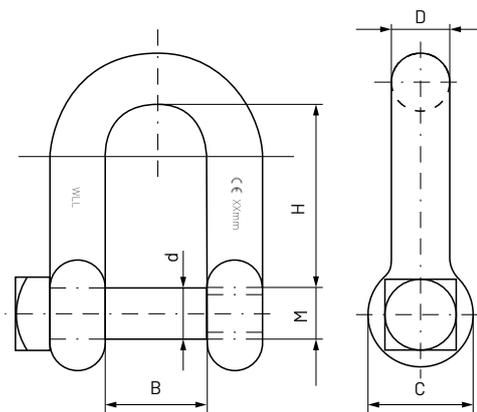
El grillete recto es el instrumento de elevación que más frecuentemente se utiliza como pieza intermedia entre una anilla, cáncamo o gancho y una eslinga.
