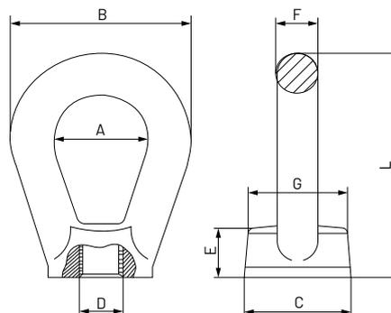
Gracias al diseño ovalado de su arco, éste facilita el encaje con todo tipo de ganchos, garantizando la seguridad y el proceso de elevación requerido.
