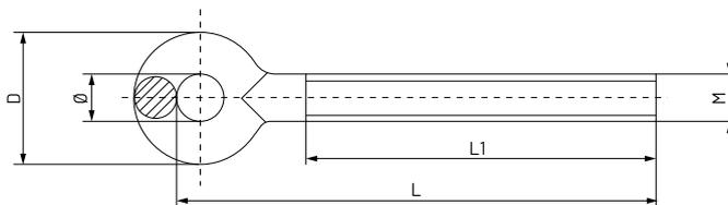
Indicado para montaje sobre un cuerpo tensor DIN 1480 o DIN 1478 y recomendado para aplicaciones donde el extremo a fijar sea un gancho.
