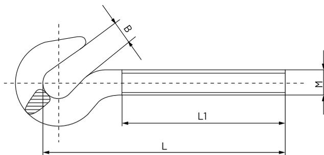
Indicado para montaje sobre cuerpo tensor DIN 1480 o DIN 1478 y recomendado para aplicaciones donde el extremo a fijar sea una anilla.
