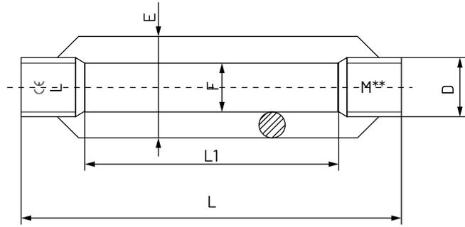
Teniendo presente que la rosca de un extremo es hacia la derecha y su opuesto es hacia la izquierda, el cuerpo del tensor CTS nos permite la aplicación de toda la gama de terminales según cada métrico.
