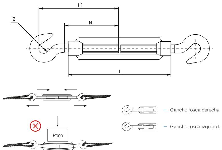
Especialmente indicado para aplicaciones dónde se requiera tensar cables con anillas, cabos con gazas, cadenas, etc.
