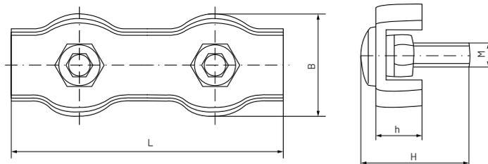
El sujetacables plano doble permite un rápido montaje además de incrementar la seguridad y su eficacia respecto al sujetacable simple, principal ventaja es el hecho de disponer de una placa que es apretada mediante dos tuercas, aprisionando así el cable en la estructura con una mayor longitud.
