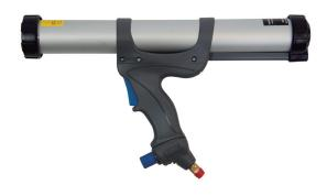
El aplicador neumático profesional está dirigido a aplicaciones industriales, cuenta con una potencia de 1,5 KN y una presión de 6,8 bar. Además cuenta con un mecanismo de acción directa, es silencioso (menos de 70 dB), compacto y con un control preciso gracias a su regulador integrado. Apto para sellantes de alta y baja viscosidad.
