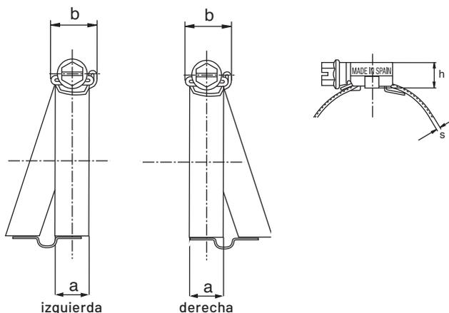
Las abrazaderas ASFA L de nueve milímetros de ancho de banda y fabricadas con un puente o con dos puentes son una solución ideal para el montaje en tubos con espiral de acero en el interior.
