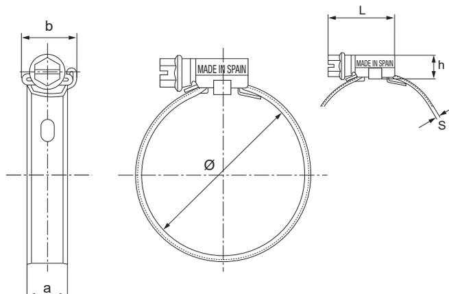
Con el objetivo de minimizar los costes de ensamblaje en las líneas de montaje, especialmente en la industria del automóvil, Mikalor ha desarrollado la abrazadera ASFA perforada con agujero de preposicionamiento, garantizando los mismos valores de par de apriete y rendimiento que la gama estándar.
