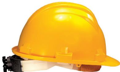
Este casco de protección está fabricado en polietileno de alta densidad y está indicado para trabajos con riesgo de recibir impactos de objetos en caída y junto a conductores eléctricos activos. Tiene una resistencia al impacto de -20º C / 50º C y un aislamiento eléctrico de hasta 400 V ac. Además cuenta con una banda antisudor, antialérgica y un ajuste mediante rueda.
