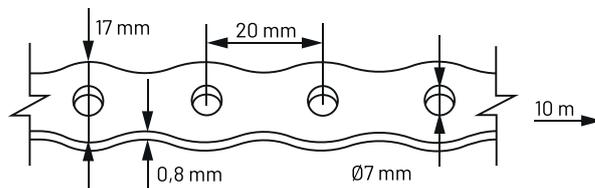
Esta cinta está fabricada en acero galvanizado y esta toda perforada, longitudinalmente. Es empleada para la sujeción de cualquier elemento que deseemos fijar atornillando a paredes, techos o suelos.
