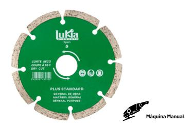
Este disco es perfecto para corte seco y está indicado para cortar materiales de construcción que no presentan una dureza ni una abrasividad excesiva (ladrillo de construcción, piedra blanda, mampostería, baldosas de cemento, azulejos de cerámica, hormigón, etc). Cuenta con pastilla segmentada, que destaca por ofrecer un gran poder, una mayor velocidad de corte y muy buena refrigeración por aire.
