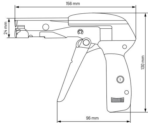
La pistola tensora-cortadora para abrazaderas de nylon admite anchuras de 2,2 mm hasta 4,8 mm y grosores hasta 1,6 mm. Una vez se le ha dado la tensión máxima, sin necesidad de realizar ninguna acción adicional, la pistola corta el sobrante de brida, quedando un corte limpio y a ras de la cabeza de la brida.
