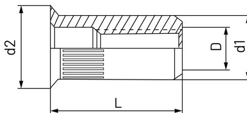
Las tuercas remachables sirven para, además de unir varias chapas metálicas, efectuar el montaje de un elemento roscado. El modelo de cabeza baja se aplica cuando es necesario que la tuerca no sobresalga de la pieza donde se ha montado.
