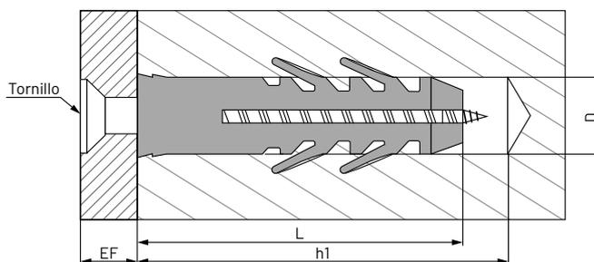
El taco de nylon standard está fabricado con poliamida 6.6 y está indicado para realizar fijaciones ligeras en materiales macizos, como hormigón, piedra, ladrillos macizos. Sus alas laterales permiten ejercer un rozamiento en el agujero que evita que el taco gire sobre si mismo en el momento del roscado.
