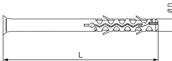
Está acabado con una arandela avellanada que evita que el taco se introduzca en el agujero. Sus dimensiones hace que la fijación realizada sea altamente efectiva y junto a su geometría, una vez roscado el elemento para la fijación en el taco, hace que adquiera una deformación y se expanda, quedando fijado en las paredes del taladro. Se presenta en un color anaranjado.
