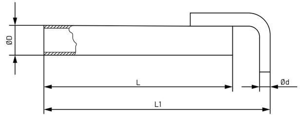
Un tubo de 47 mm de diámetro con un apéndice de 18 mm, también de acero, en su extremo, permite que el andamio quede fijado a la fachada. La prolongación en un extremo va fijada al andamio mediante una grapa y por el otro extremo el del apéndice en forma de L permite que sea introducido en la argolla de diámetro 24 mm, quedando fijado el andamio a la fachada.
