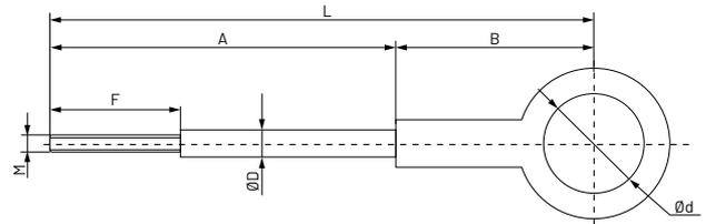
Anclaje con rosca métrica que permite ser roscado en el taco metálico para fachadas y andamios de M10 una vez roscado activa el sistema del taco metálico que se expande en el interior del agujero generando una presión en las paredes, quedando una fijación altamente segura. La argolla de 50 mm permite introducir cualquier elemento que ayude a la fijación como son las prolongaciones para andamio de tubo de 47 mm.
