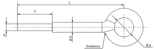
Anclaje con rosca métrica que permite ser roscado en el taco metálico para fachadas y andamios de M8 una vez roscado activa el sistema del taco metálico que se expande en el interior del agujero generando una presión en las paredes, quedando una fijación altamente segura. La argolla de 24 mm permite introducir cualquier elemento que ayude a la fijación.
