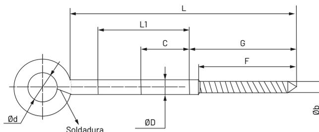
Anclaje pensado para trabajar con el taco de nylon de poliamida de diámetro 14 mm. Ideal para hormigón armado, hormigón, hormigón hueco, hormigón celular, ladrillo macizo, ladrillo hueco, piedra, etc. Su argolla de diámetro 24 mm permite fijar cualquier elemento aunque su uso está muy extendido en andamios. Existen prolongaciones para fijar andamios a fachadas y que su extremo está pensado para este tipo de anclaje.
