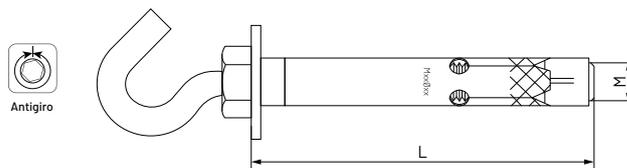
El funcionamiento es el mismo que los anclajes metálicos con tornillo. Es necesario realizar un taladro previamente donde ubicar el anclaje y mediante la expansión de la camisa una vez realizado el roscado del gancho se produce el anclaje por presión en las paredes del material base. El gancho permite colgar el elemento a fijar.
