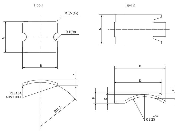
El clip botón se utiliza para la fijación de elementos plásticos, moldeados o botones de mando.
