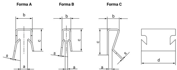
Las grapas para ensamblaje GRU son unos elementos de fijación de doble pestaña, con posicionamiento de apuntado exterior, que ensamblan mediante una doble presión.
