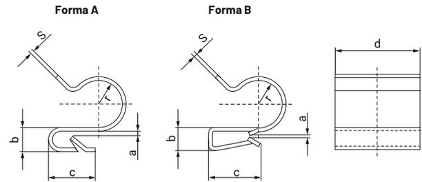
El clip para cable CLG tiene por misión fijar cables o conducciones tubulares a elementos de chapa o soportes en general. Consta de una base con un dispositivo elástico en forma grapa para poder quedar sujeto en el panel, y un brazo superior con posicionamiento de apuntado exterior y dirección inversa al dispositivo antes citado que fijará el cable aplicado.
