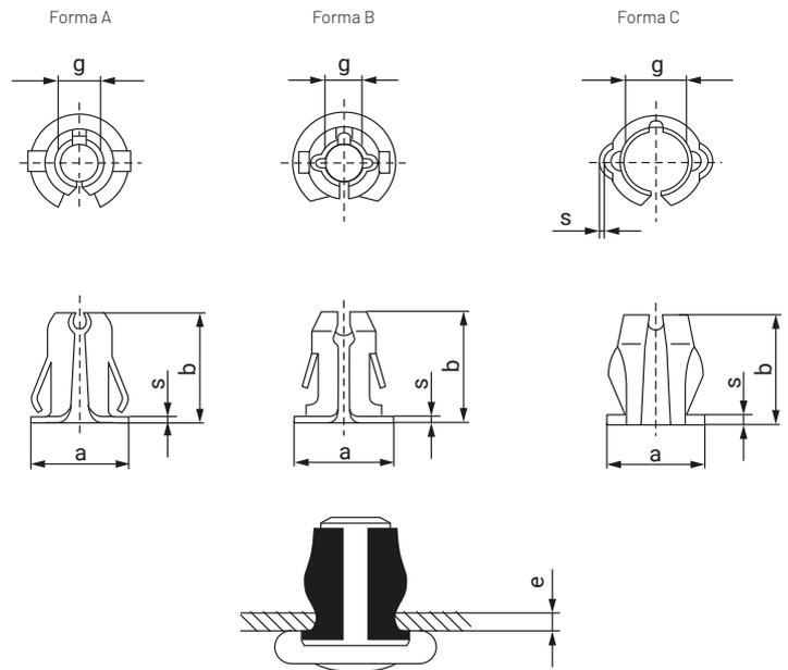
El clip tubular SCL compone un grupo dentro de las fijaciones que utiliza el remache como elemento complementario. Puede compararse a la tuerca de auto-retención para una utilización en montajes ciegos, y en donde otras fijaciones más convencionales se muestran inaplicables.
