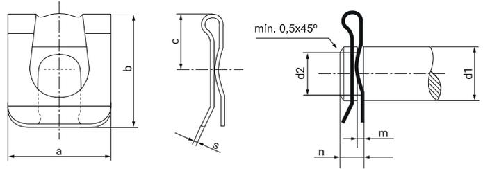
El clip de seguridad CLS es un elemento de fijación compuesto de dos pestañas con posicionamiento exterior. Una de las pestañas tiene la parte inferior abierta y con una ligera curvatura para quedar correctamente fijada en la ranura del eje, quedando la pestaña restante sujeta al eje propiamente dicho. Esta gama de clip de seguridad sólo puede aplicarse en ranuras localizadas en los extremos de los ejes.
