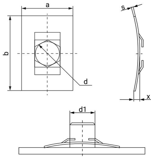
La sujeción rápida para ejes SRR, es un elemento de sujeción rectangular con el orificio de entrada del eje situado en su centro. Resulta indicado para montajes que no deban ser desmontados habitualmente, ya que para hacerlo es preciso romperla.
