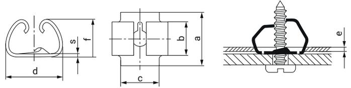
La tuerca de expansión es una tuerca de autofrenado que confiere una gran seguridad y resistencia a las vibraciones. Está diseñada especialmente para los ensamblajes ciegos, accesibles desde un solo lado, en el centro o alrededores del panel.
