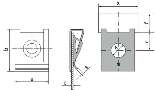
La tuerca rápida universal TRU es un elemento de fijación compuesto de dos pestañas con un posicionamiento de apuntado exterior que proporciona una doble presión elástica. La pestaña superior está seccionada de forma longitudinal por cada lado, provocando también un posicionamiento de apuntado interior que repercute en una mayor presión de agarre al panel aplicado. Para la utilización de esta tuerca se precisa un tornillo de roca DIN 7970 o de rosca ACME, según el grupo de gama elegido.
