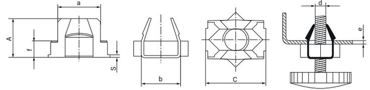
La tuerca enjaulada de nivelación confiere una gran seguridad y resistencia a las vibraciones diseñadas para resolver el problema de fijación de los pies regulables en la industria de electrodomésticos, del mueble metálico y en general.
