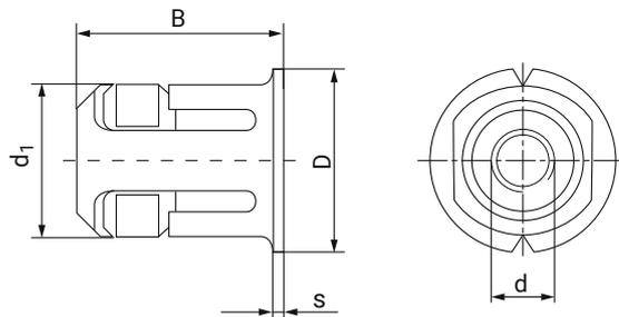
Las tuercas enjauladas combinan las clásicas cualidades de elasticidad de los elementos de ensamblaje y la gran resistencia de las tuercas de acero con sus múltiples filetes. Están diseñadas para realizar cualquier tipo de montaje, incluidos los montajes ciegos. Permiten ser fijadas en sus elementos por tornillos y ser sometidas a pares de apriete elevados o a cargas axiales importantes.
