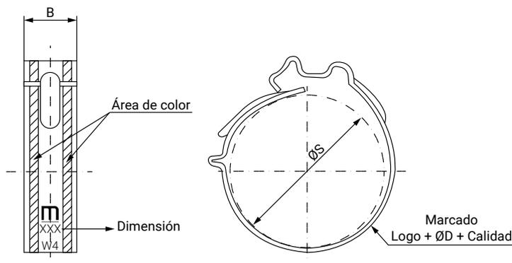
Las abrazaderas clip están fabricadas partiendo de fleje inoxidable y de una sola pieza.
