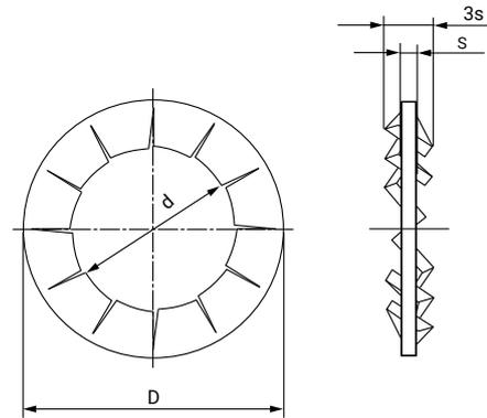
“Las arandelas dentadas según norma DIN 6798 nos permiten inmovilizar elementos de unión especialmente tuercas, tornillos y pernos sujetos a vibraciones, manteniendo uniforme el par de apriete aplicado sobre el elemento de fijación en cualquier montaje mecánico, eléctrico y electrónico.
