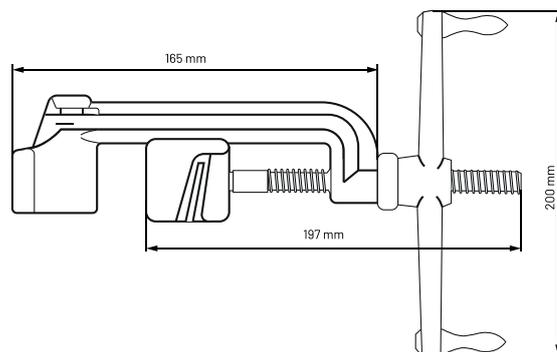
Esta herramienta está diseñada para la cinta universal inoxidable, tanto la ligera como la pesada, y permite realizar el tensado y un corte final limpio.
