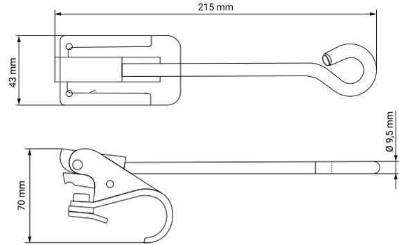
Esta herramienta es un accesorio que se emplea juntamente con el tensor y permite realizar el corte final sin dejar partes que sobresalgan del diámetro fijado, evitando de este modo daños por arañazos o rasgaduras.
