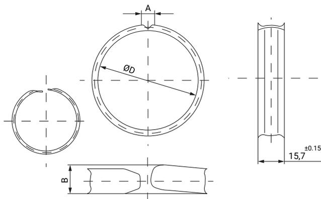
El aro de seguridad para abrazaderas ASFA S con un ancho de banda de 12 mm está pensado y diseñado para dar una mayor protección al tubo sobre el sistema de fijación de la abrazadera.
