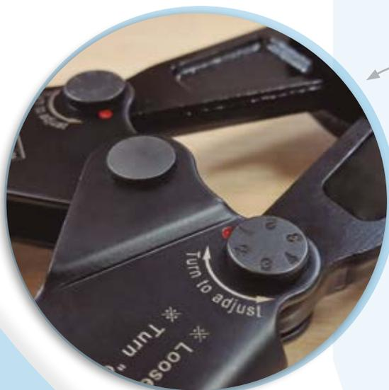
Dispone de dos botones de ajuste que permiten una calibración óptima de la fuerza a realizar según el uso que se le da a la herramienta.
